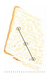
L'utilisation d'un magnétomètre à proton de grande précision a permis de mettre en évidence des anomalies linéaires d'intensité relative plus faible que l'encaissant de l'ordre de 1 à 4 nT. La comparaison des anomalies linéaires identifiées sur la carte de champ magnétique total avec la photographie aérienne de la parcelle a permis de confirmer la présence d'un émissaire aligné le long de trois anomalies ponctuelles
