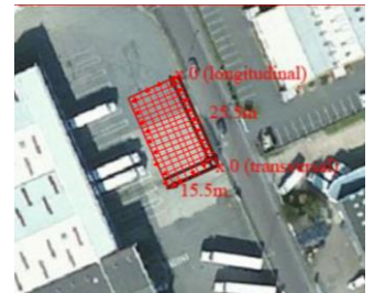
Mise en place d'un carroyage au bureau sur SIG et sur le terrain
