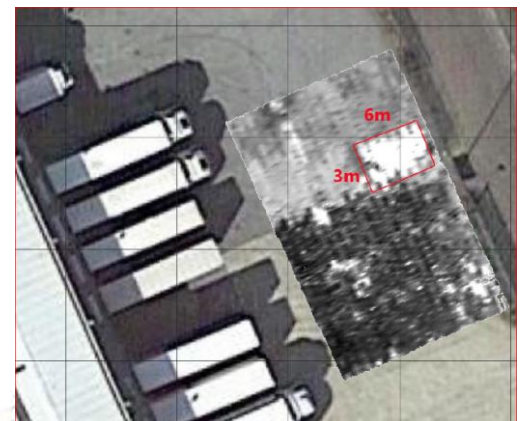
Création de shapefiles sous SIG produites à partir des traitements 3D de données géoradar Localisation des structures de la cuve 3m x 6m
