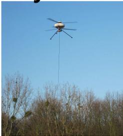
Le survey se fait avec un drone hélicoptère muni d'un magnétomètre Bartington 3 axes MAG03MC70 fluxgate. Ce magnétomètre possède une gamme d'analyse de +/- 0,07 nT. Le drone se déplace à 30km/h en vol automatique à une hauteur de 10m au-dessus du sol. Le parcours est organisé en lignes parallèles espacées de 5m.
