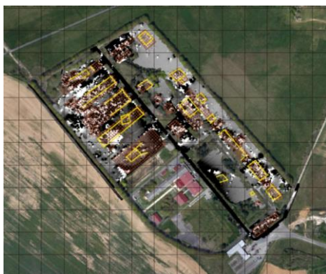
Création de shapefiles sous SIG produites à partir des traitements de données magnétométriques Localisation des structures enterrées et des réseaux
