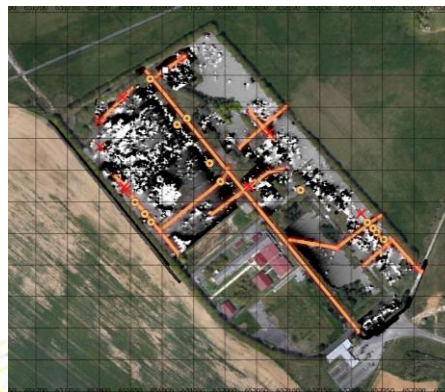
Création de shapefiles sous SIG produites à partir des traitements de données magnétométriques Localisation des structures enterrées et des réseaux
