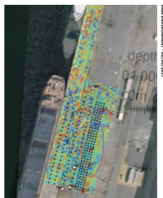
Cartes 2D géoradar en fonction de la profondeur Corrélation entre cibles magnétomètre et cibles géoradar
